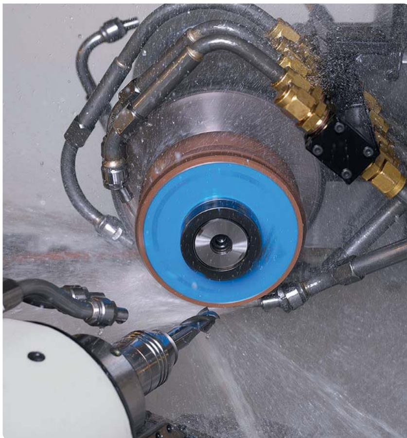
La gamme d'huile entière Blasomill GT est parfaitement adaptée à l'usinage haute pression, même à plus de 30 bars.
