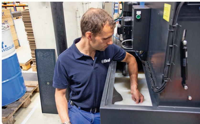
Une station de recyclage des huiles de coupe, une solution pour réduire le coût d'usage de son lubrifiant.
