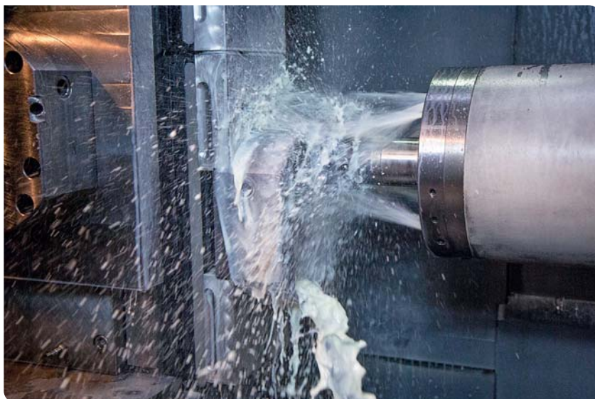
Projection d'une huile B-Cool MC 610 lors d'une opération d'usinage.
