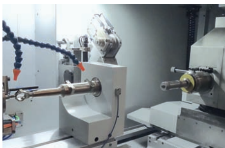
► En rectification intérieure, l'outil liquide apporte des gains de productivité et de qualité afin de limiter le besoin de superfinition
