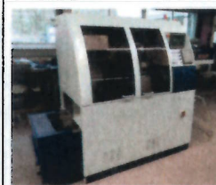
TOUR AUTOMATIQUE CNC TORNOS DECO 10 Révisé 10 axes Robobar SSF
